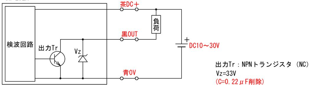
従来品では出力信号に含まれるリップル信号の影響を防ぐ目的で、出力回路にコンデンサ(C=0.22 $\mu F$ )を設けています。このコンデンサにより出力信号に適度な遅延時間を与える事で、リップル信号の影響を防ぐよう回路が設計されています。変更品では回路の見直しを行い、出力信号にリップル信号の影響が現れない回路構成としたためコンデンサを排除しました。
